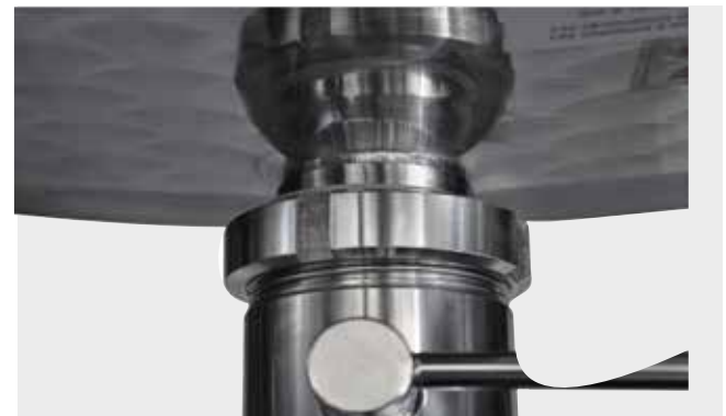
Brushed TIG exterior welding of DIN sleeve coupling Saldatura a TIG spazzolata esterna di manicotto DIN
