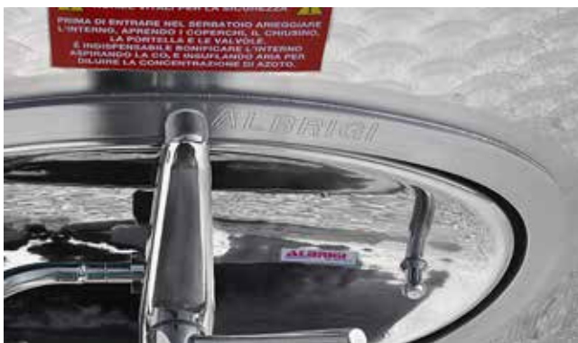
External oval manual TIG welding of hatch Saldatura a TIG manuale su portella ovale all'esterno
